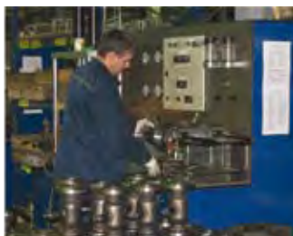
Тестирование шаровых кранов
